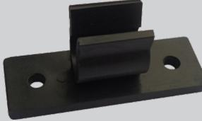
Kolbenhalterung, PA66 Kunststoff, 2 Schraub- oder Klebemontage, für Kolben- $\varnothing$  8mm, max. Temperatur 80°C
