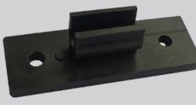
Kolbenhalterung, PA66 Kunststoff, 2 Schraub- oder Klebemontage, für Kolben- $\varnothing$  5-6mm, max. Temperatur 80°C
