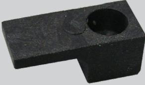
Kolbenhalterung, Verstärktes PC-ABS, Schraubmontage, für Kolben- $\varnothing$  5-6mm, max. Temperatur 90°C
